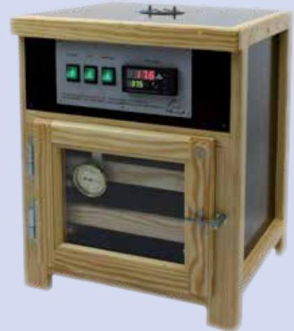
Abb.: A 35 mit halbaut. Wendung und Digitalanzeige
