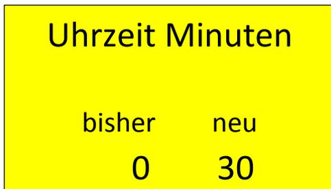
Wählen Sie nun den gewünschten Wert durch rechts-oder linksdreh des Knopfes. Haben Sie den gewünschten Wert erreicht, bestätigen Sie diesen durch ein kurzes drücken des Einstellknopfes. Sie befinden sich nun wieder bei **Uhrzeit Minuten**.
