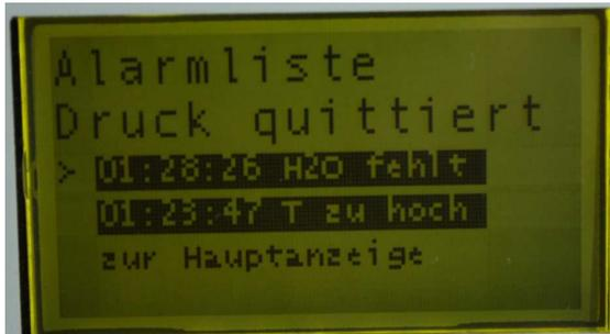
3. Die Alarmliste wird angezeigt und die Uhrzeit des Alarmbeginns wird angezeigt. Je nach Zustand können mehrere Alarme in der Liste vorliegen. Z.B. H2O Alarm oder Temp. Max Alarm.
