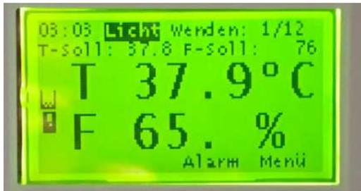
Drücken Sie in dieser Position auf den Knopf, dann wird die Innenraumbeleuchtung eingeschaltet. Gleichzeitig ändert sich der Schriftzug von „Licht“ auf „LICHT“. Ist die Bezeichnung einer Funktion in Großbuchstaben dargestellt, so ist sie auch aktiviert.
