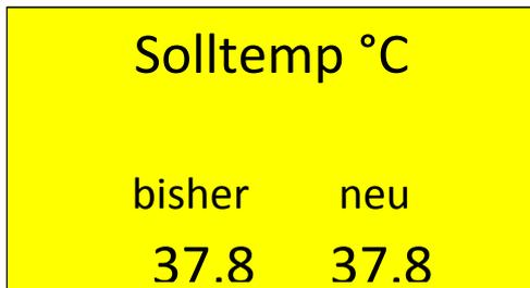
Wählen Sie nun den gewünschten Sollwert durch rechts-oder linksdreh des Knopfes. Haben Sie den gewünschten Wert erreicht, bestätigen Sie diesen durch ein kurzes drücken des Einstellknopfes. Hiermit wird der eingestellte Wert gespeichert.
