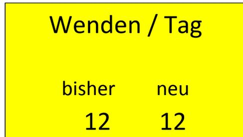
Wählen Sie nun den gewünschten Wert durch rechts-oder linksdreh des Knopfes. Der Wert darf nur bei 12 oder darunter liegen, da die Wendung 2 Stunden für eine Wendung benötigt.
