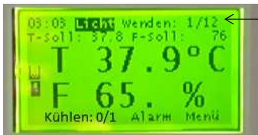
Blinken bedeutet: Wendung wird gerade ausgeführt
