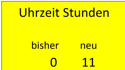
Wählen Sie nun den gewünschten Wert durch rechts-oder linksdreh des Knopfes. Haben Sie den gewünschten Wert erreicht, bestätigen Sie diesen durch ein kurzes drücken des Einstellknopfes. Sie befinden sich nun wieder bei **Uhrzeit Stunden**.
