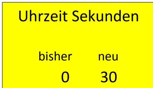
Wählen Sie nun den gewünschten Wert durch rechts-oder linksdreh des Knopfes. Haben Sie den gewünschten Wert erreicht, bestätigen Sie diesen durch ein kurzes drücken des Einstellknopfes. Sie befinden sich nun wieder bei **Uhrzeit Sekunden**.
